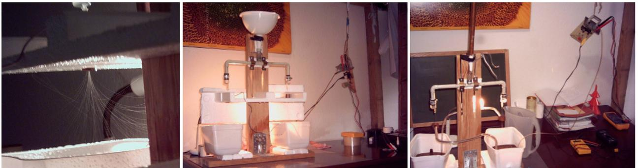
**Bild 4** Links: Auffächerung des Wasserstrahls unter einem Ring; Mitte: Ladungsverstärker etwa in Höhe der Düse, rd. 50 cm entfernt; rechts: Ladungsverstärker am gleichen Aufhängepunkt, aber 30 cm höher.
